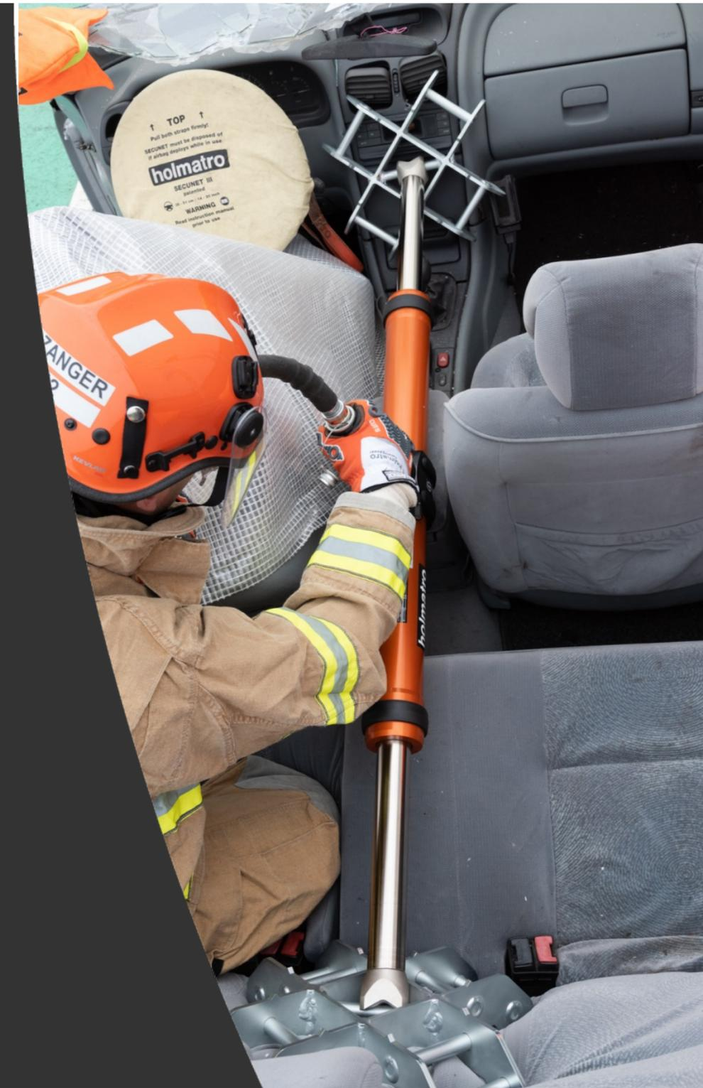
确保顶杆不接触中央控制台，以防止柱塞滑动
