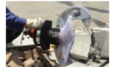
Une combinaison parfaite : écraser du béton avec la CC 23 et couper les barres d'armature avec la mini-cisaille CU 4007 C ou SMC 5006
