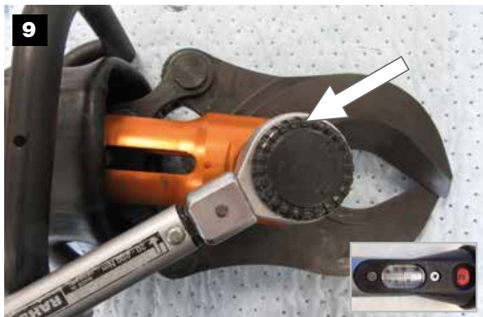
9 50 Nm (41mm) Check torque and spray all hinge points with Teflon spray. Controleer het moment en spuit alle scharnierpunten in met Teflon spray.
